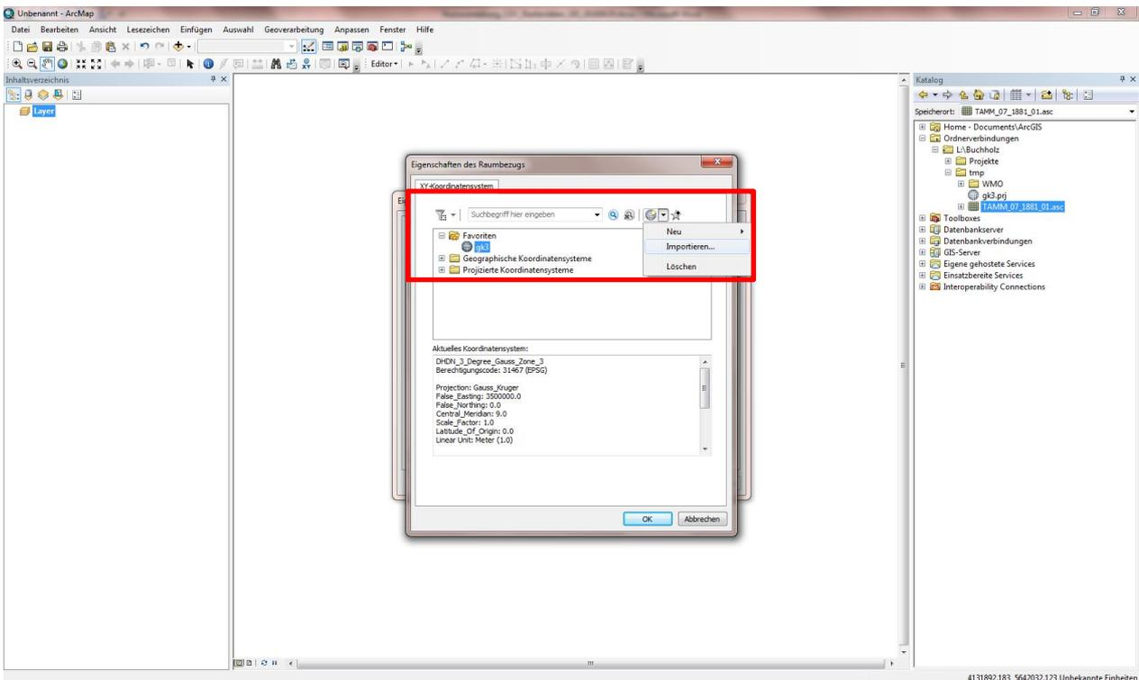
Danach können sie den Rasterdatensatz einfach per „drag and drop“ vom ArcCatalog in das Inhaltsverzeichnis (links) ziehen. Die ausgewählten Daten werden dann in ArcMap dargestellt. Im Anschluss daran können die Daten weiter bearbeitet werden.
